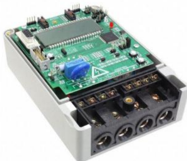
Figure-5. Smart Meter
